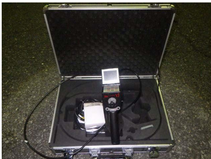
図 31：内視鏡（先端可動式）
