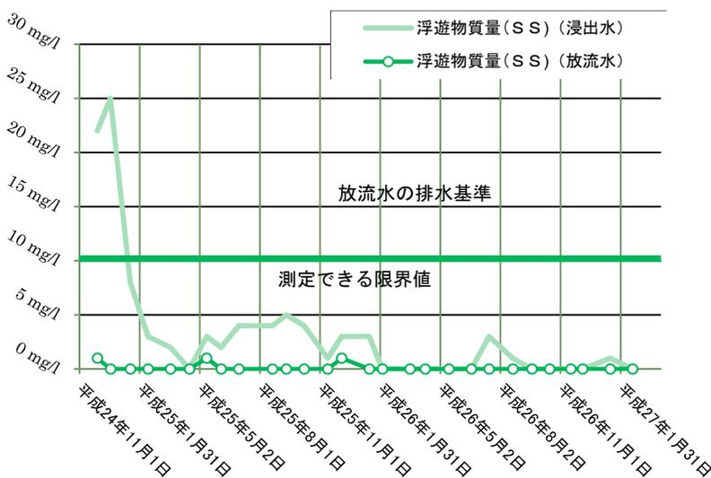
図：浮遊物質量の測定結果
