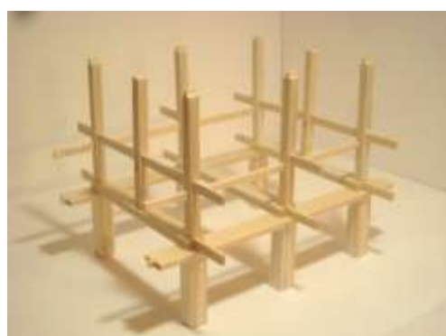
6 : 貫の取り付け
