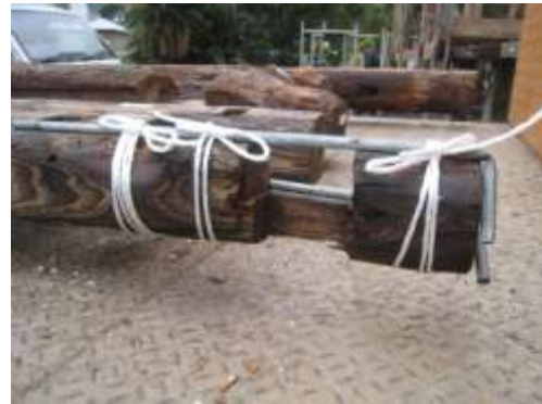
梁仕口の折損
